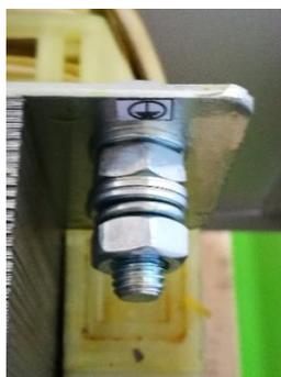
Collegare a terra il bullone di terra posizionato sulla struttura del trasformatore.
