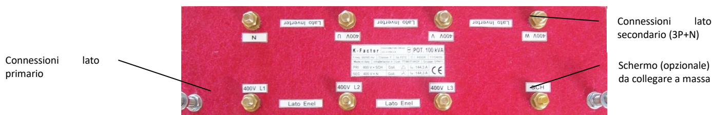
Tipica piastra collegamenti dei modelli TTI (nella foto il collegamento Dyn11)
